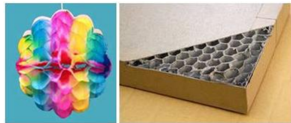
受到七夕折纸装饰（左）启发，蜂窝结构芯材问世。右图为瓦楞纸制蜂窝结构纸板（图片提供：萩原特聘教授）
